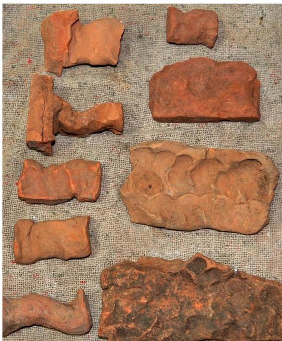
Рис. 3. Исторические приспособления для разделения изразцов при обжиге. Фото Е. М. Болдыревой
