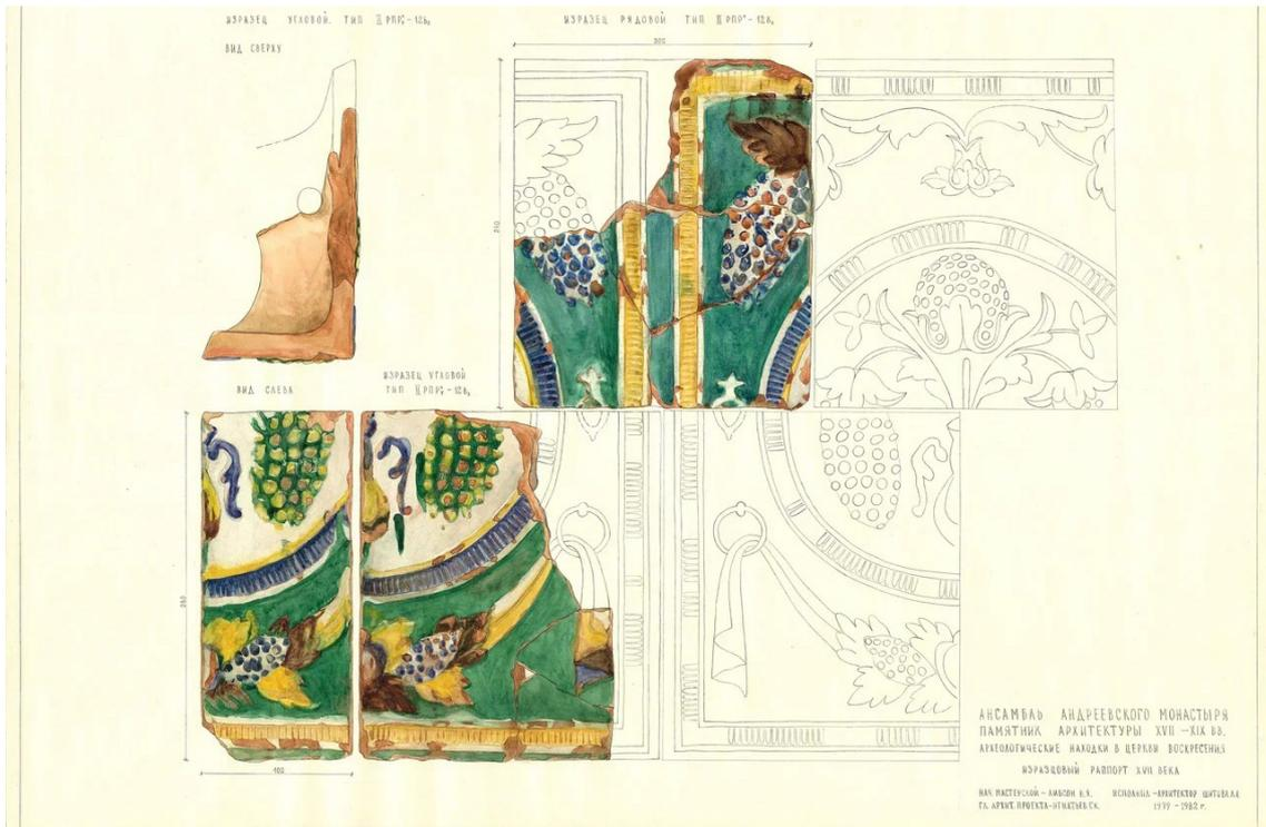
Рис. 3. Изразцовый раппорт «Ваза с плодами в рельефном кольце» (высота 48 см). Чертеж Л. А. Шитовой
