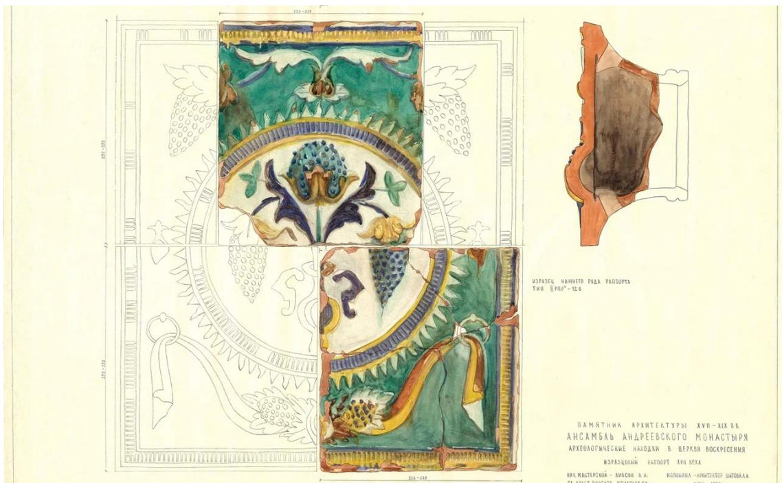
Рис. 4. Изразцовый раппорт «Ваза с плодами в рельефном кольце» (высота 50 см). Чертеж Л. А. Шитовой
