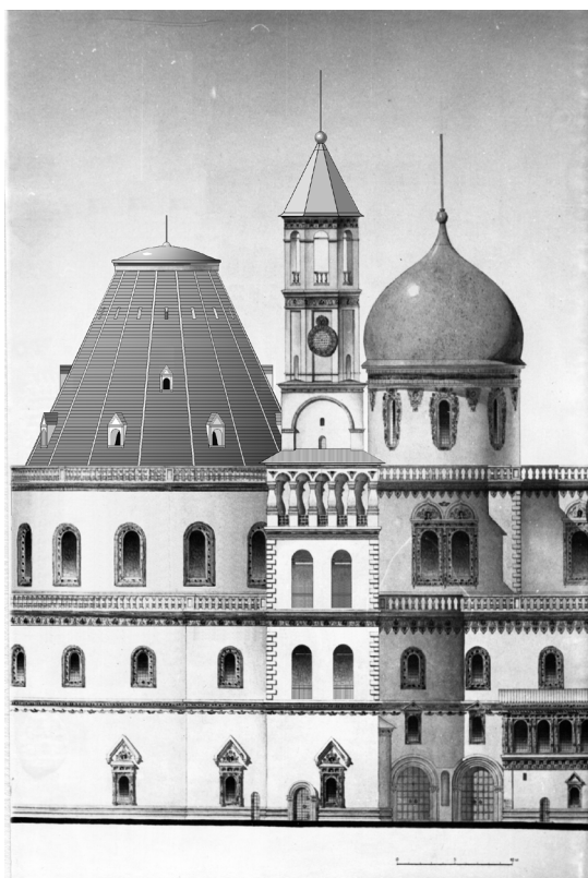
Рис. 4. Южный фасад Воскресенского собора в конце XVII – нач. XVIII в. (центральная часть). Реконструкция Л. Э. Тепфера (1984 г.) с корректировками К. В. Акинина (шатер, количество проемов в третьем ярусе ротонды, покрытие колокольни; 2015, 2025 гг.). Исходная реконструкция опубликована: [Тепфер, 2002, с. 130]; материалы для корректировки (из: [Бугаева и др., 1988, с. 32 (М. Б. Чернышев); Акинин, 2003 (только композиция шатра); Акинин, 2021, с. 32–39])
