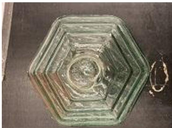
Рис. 17. Кирпич стеклянный «Фальконье» Модели № 7 модуль «1» (уменьшенный вариант). Швейцария. Начало XX века. ГНИМА ОФ-6536/1. Р VIII-2028
