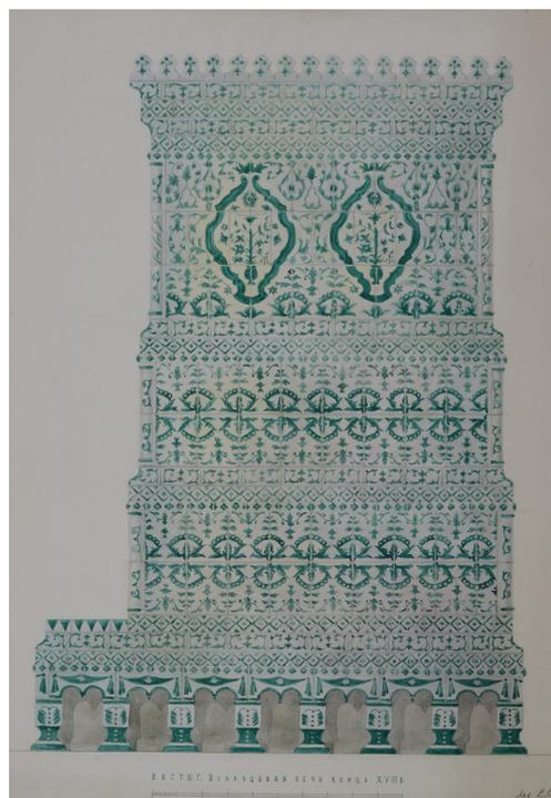
Рис. 8. С. А. Маслих. Торцевая часть печи с лежанкой, облицованная двухцветными изразцами производства Великого Устюга из трапезной палаты второго этажа Вознесенской церкви Великого Устюга. Конец XVIII – начало XIX века. Реконструкция. Акварель. Копия. Музей архитектуры им. А. В. Щусева (Москва), ИНВ № PV 6731/1
