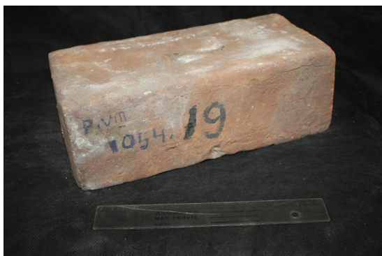
Рис. 12. Кирпич большемерный. Из стены Китай-города (Москва). Кирпич. Начало XVII века. ГНИМА ОФ-1811/19. Р VIII-1054 Fig. 12. Large-sized brick. From the wall of Kitay-gorod (Moscow). Brick. The beginning of the 17th century. GNIMA OF-1811/19. P VIII-1054
