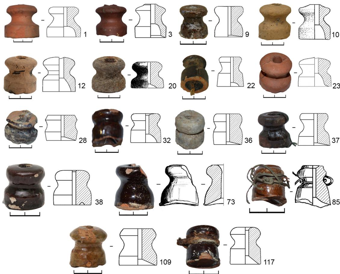
Рис. 2. Тип 1, подтип 2. Ролики цилиндрические приземистые с головкой овального профиля
