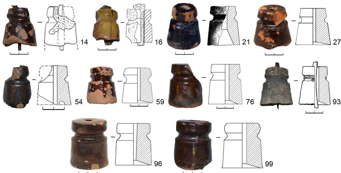
Рис. 7. Тип 2. Ролики конические – в виде усеченного конуса с плоской вершиной и широким основанием
