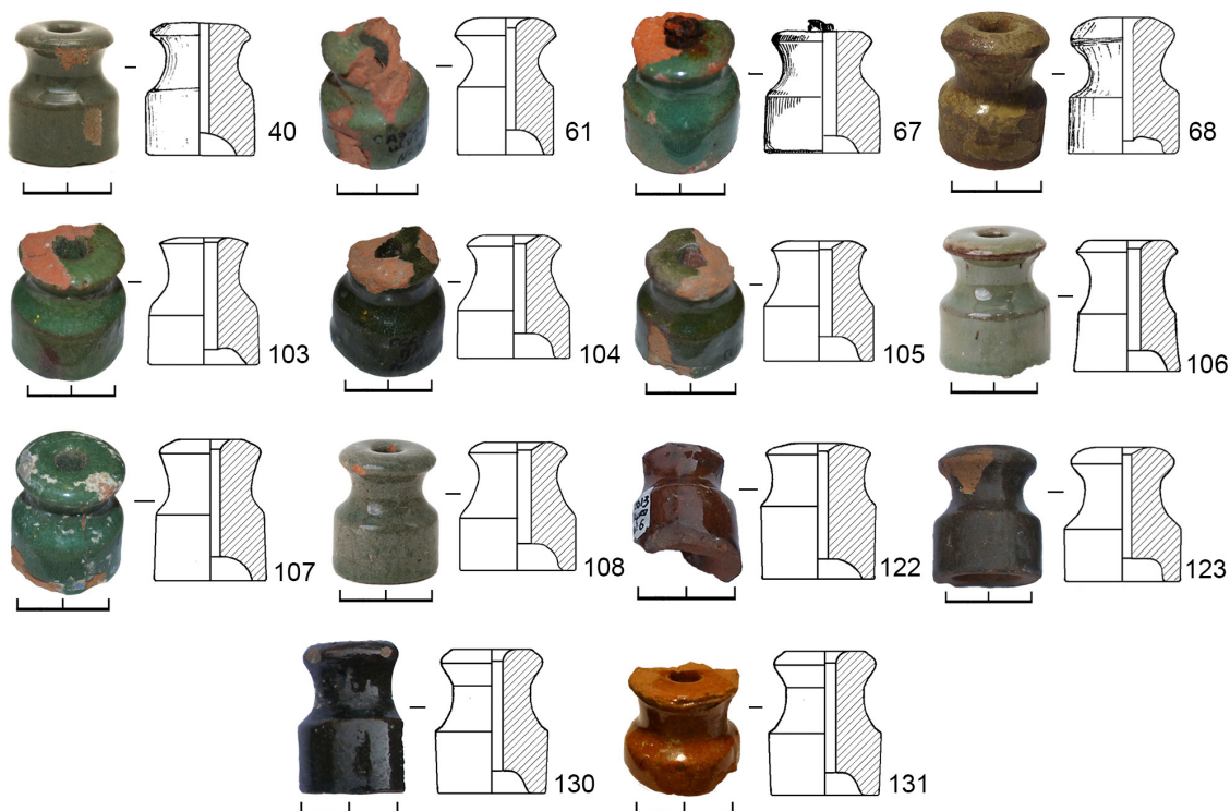
Рис. 6. Тип 1, подтип 6. Ролики цилиндрические с реберной головкой, стандартные, штампованные
