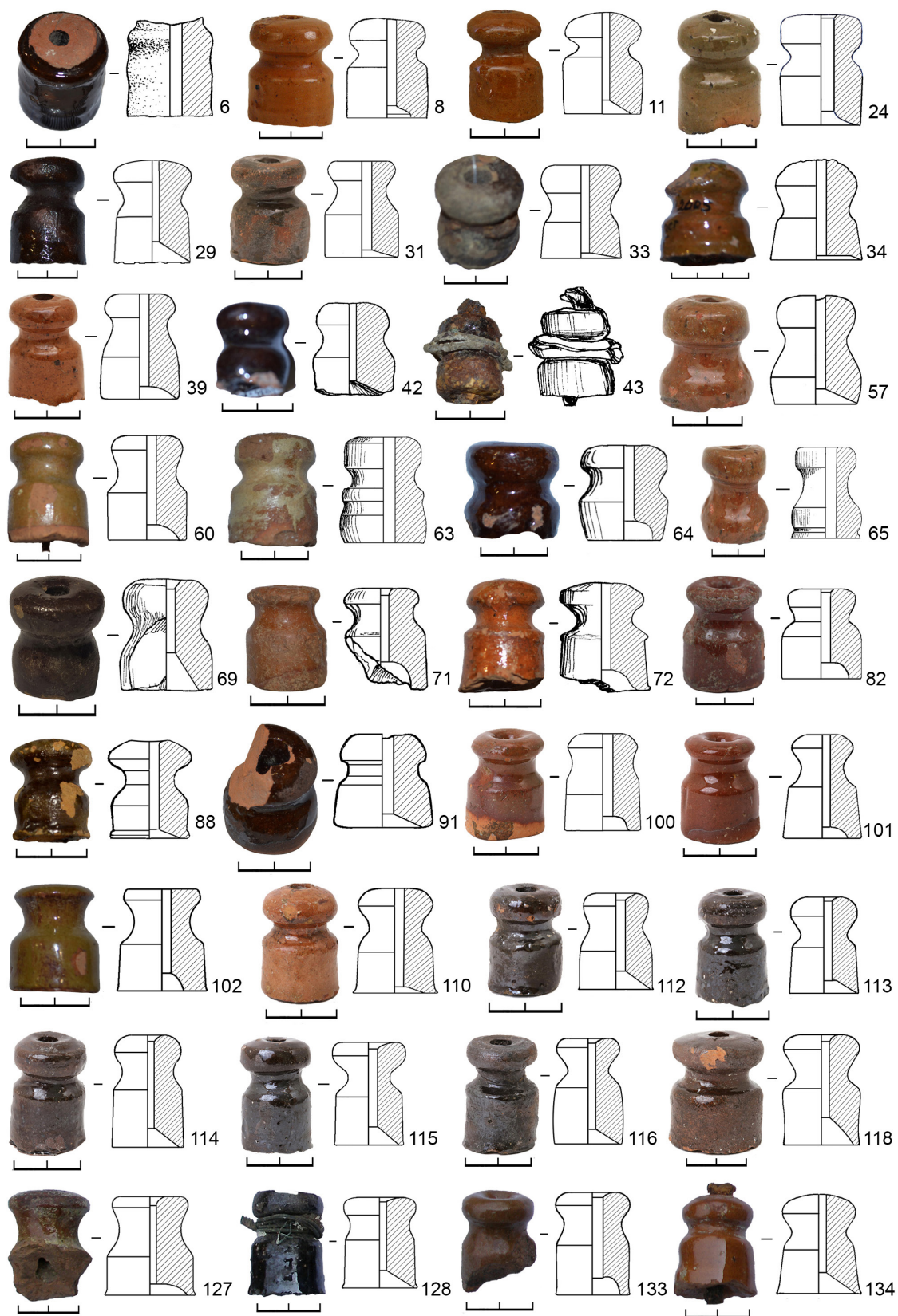
Рис. 3. Тип 1, подтип 3. Ролики цилиндрические вытянутые с головкой овального профиля
